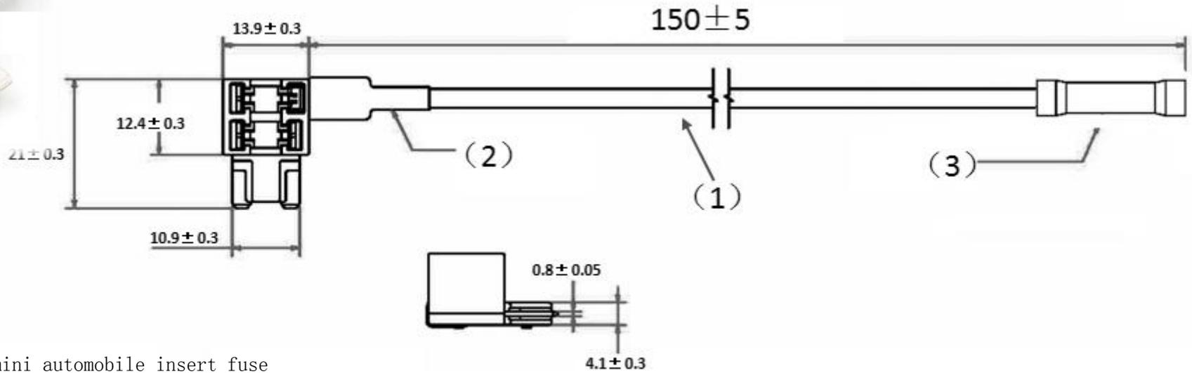
Suitable for mini automobile insert fuse
